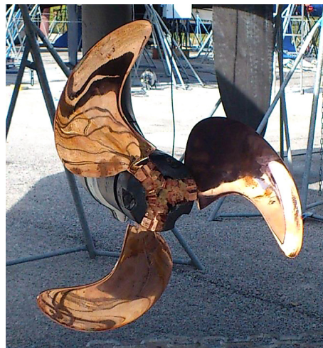
Foldingpropeller på drev. Bladen är förkopprade, men inte navet som däremot är målat med antifoulingfärg.
